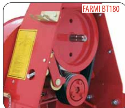
Ременной привод BT180, используемый в качестве устройства увеличения скорости, удваивает скорость, а следовательно, производительность измельчения и выброса. Однако это приводит к большому потреблению мощности, производимой трактором.
